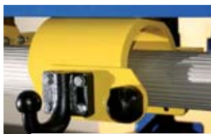
Адаптер для монтажа на транспортные средства с рамой Т-образной формы. Полностью из алюминия. Дополнительный вес с болтами 5 кг.
